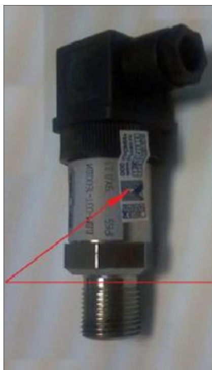
Рисунок 2 – Место пломбирования датчиков ДДМ-03Т-ДИ
